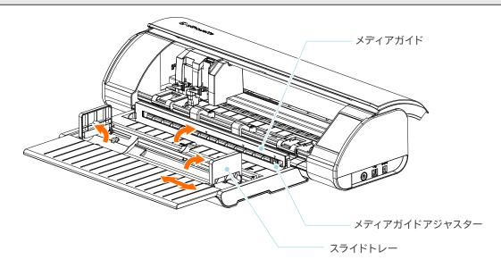
4 左右のスライドトレーを直立にセットし、右側スライドトレーの位置をメディアの幅に合わせて調整します。
