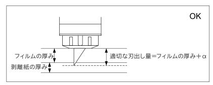
カッティングにおいて最も大事な設定が、刃出し量の調整です。 カットするメディアの厚さより若干多く刃が出るように調整してください。 カッティングフィルムをカットする場合は、フィルムより多く、剥離紙を貫 通しない程度に刃を出してください。
