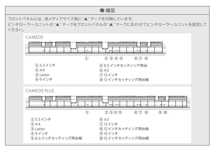
3 メディアの先端をレール下側にあるピンチローラーに突き当てて、真っ直ぐにセットします。 このとき、メディアを両手で左右に強く引っ張り、ピンと張った状態でセットしてください。
