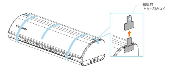
3 カバーを開けて、各パーツを固定しているテープ(青色)、保護シート(2枚)、緩衝材(5個)を取り外します。
