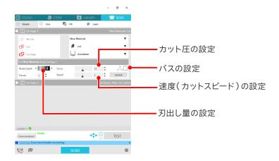
① 刃出し量:カット時に、指定した分だけ自動で刃を出します。(オートブレードのみ) カットするメディアより若干多く刃が出るように設定してください。
