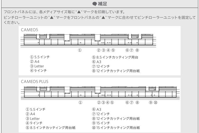
4 メディアの先端をレール下側にあるピンチローラーに突き当てて、真っ直ぐにセットします。 このとき、メディアを両手で左右に強く引っ張り、ピンと張った状態でセットしてください。
