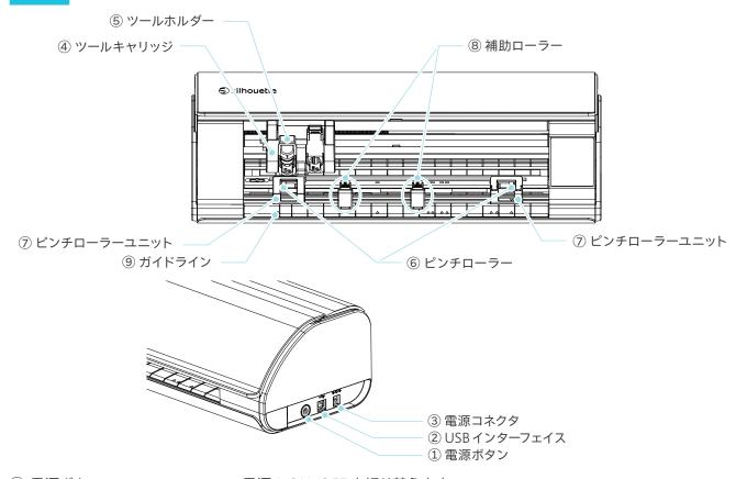
① 電源ボタン : 電源の ON/OFF を切り替えます。
