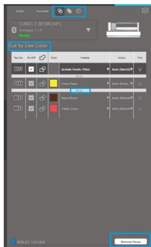
同じジョブで 2 種類以上のツールを使用したい場合、動作の間に Silhouette カッティングマシンを停止させ、必要に応じてツールを変更するため、右クリックで一時的停止を追加することができます。
