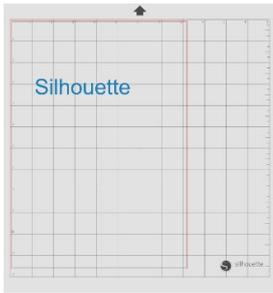
この方法で表示している時、赤い線はまだカッティングエリアに現れています。このカッティングエリアの外にある画像は切り取られません。キャリアシートの暗いエリアはプリンターの印刷余白エリアを表しており、参照用です。
